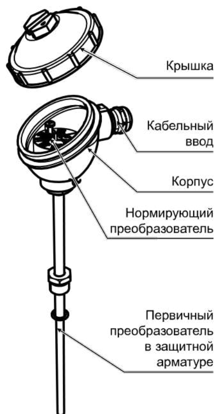
Рисунок 3.1 – Устройство датчика
